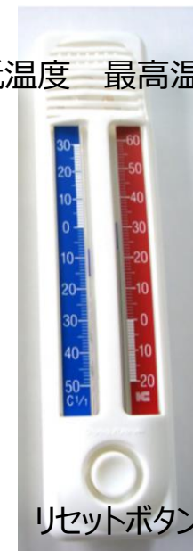
最高最低温度計の例
