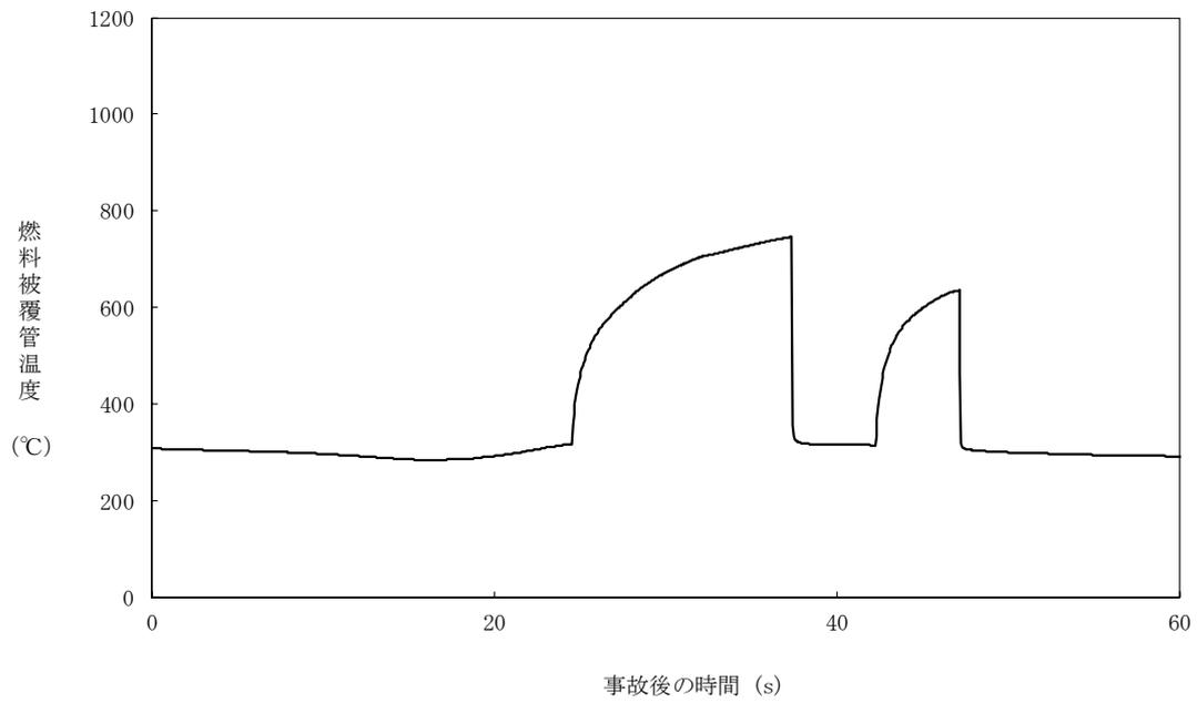
図 5.3.4-7 燃料被覆管温度の時間変化（原子炉圧力制御系の故障+CCF）
