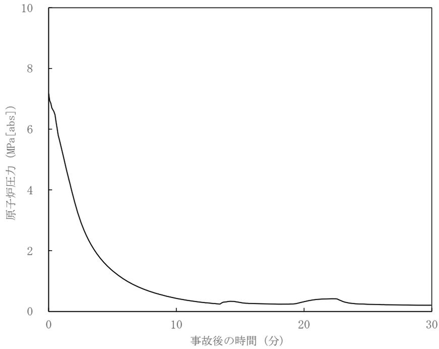
図 6.1.1-2 原子炉圧力の時間変化（給水配管破断+CCF）
