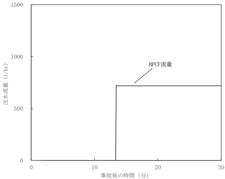
図 6. 1. 1-5 HPCF 注水流量の時間変化（給水配管破断+CCF）
