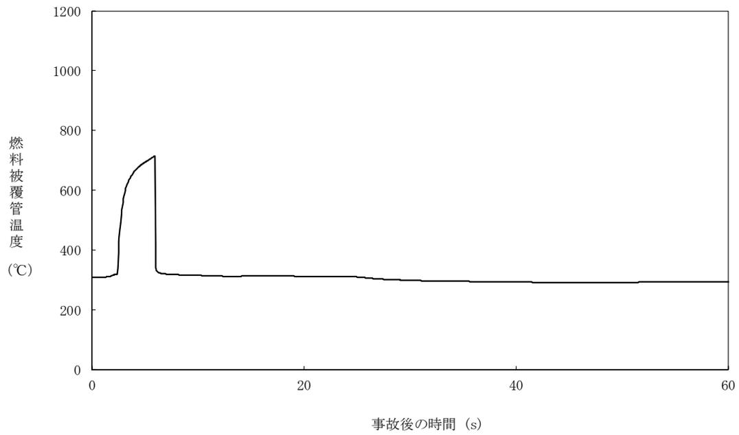
図 5.3.2-7 燃料被覆管温度の時間変化（主蒸気隔離弁の誤閉止+CCF）
