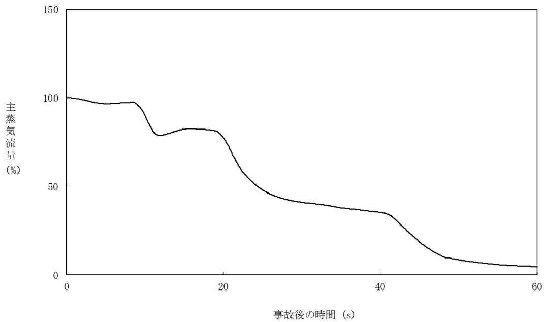
図 5.3.5-4 主蒸気流量の時間変化（給水流量の全喪失+CCF）
