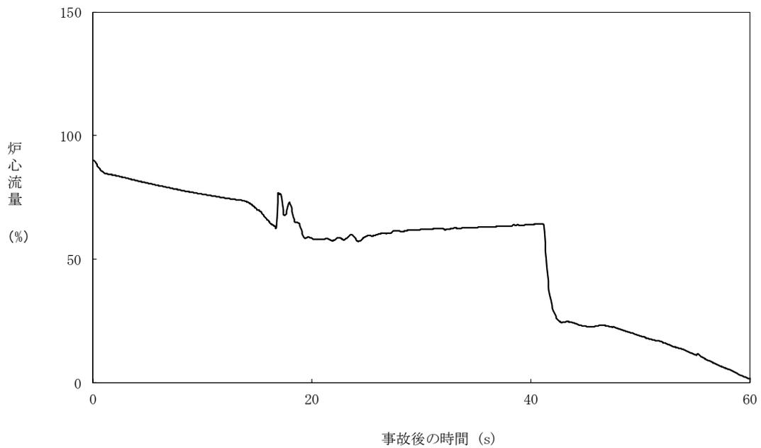
図 5.3.4-2 炉心流量の時間変化（原子炉圧力制御系の故障+CCF）
