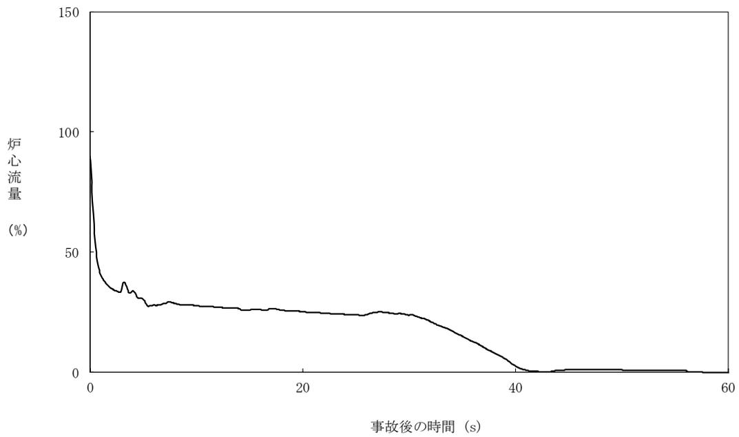
図 6. 1. 2-2 炉心流量の時間変化 (原子炉冷却材流量の喪失+CCF)
