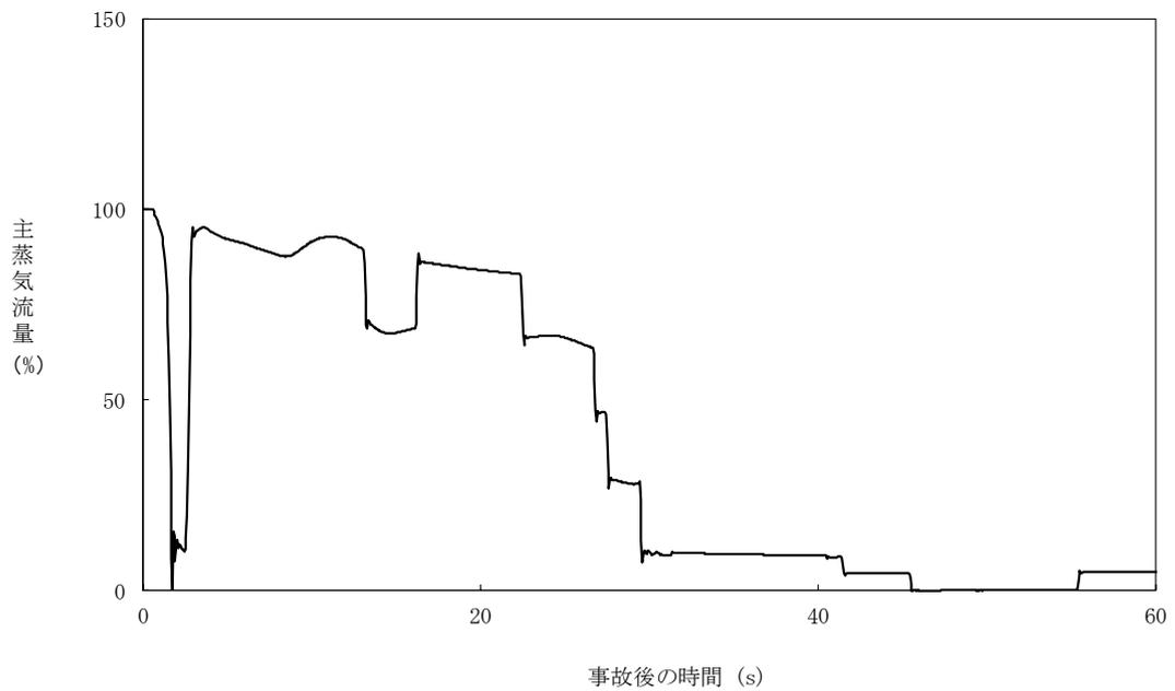
図 5.3.2-4 主蒸気流量の時間変化（主蒸気隔離弁の誤閉止+CCF）
