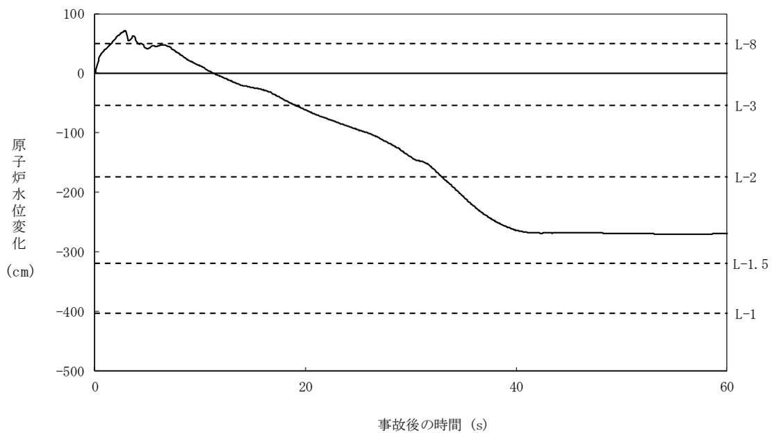
図 6. 1. 2-6 原子炉水位(シュラウド外水位)の時間変化 (原子炉冷却材流量の喪失+CCF)
