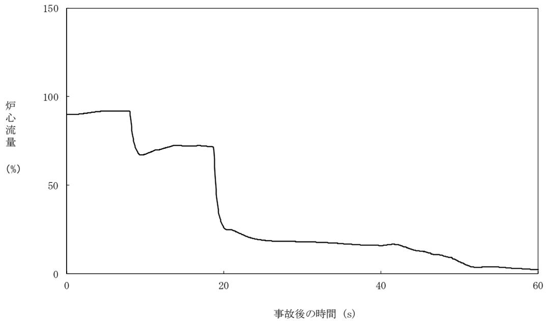
図 5.3.5-2 炉心流量の時間変化（給水流量の全喪失+CCF）
