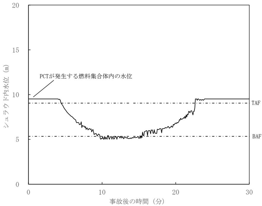
図 6. 1. 1-4 原子炉水位（シユラウド内水位）の時間変化
