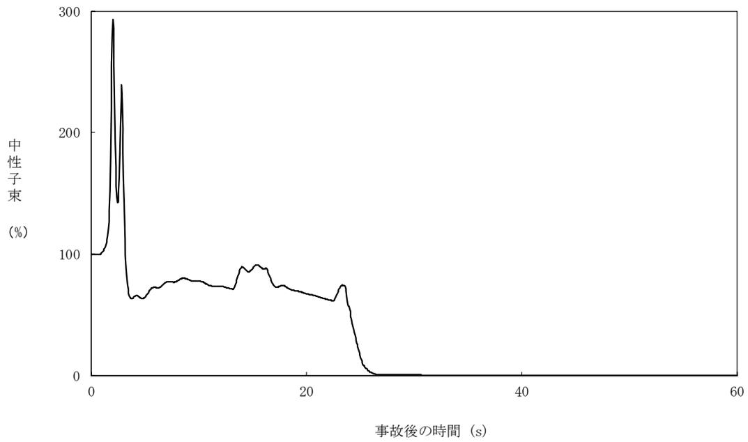
図 5.3.2-1 中性子束の時間変化 (主蒸気隔離弁の誤閉止+CCF)
