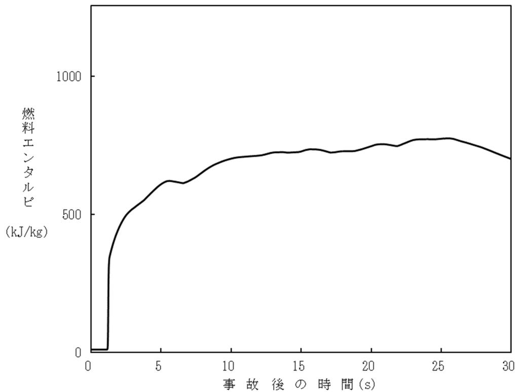
図 6.2.1-2 燃料エンタルピの時間変化 (制御棒落下+CCF)
