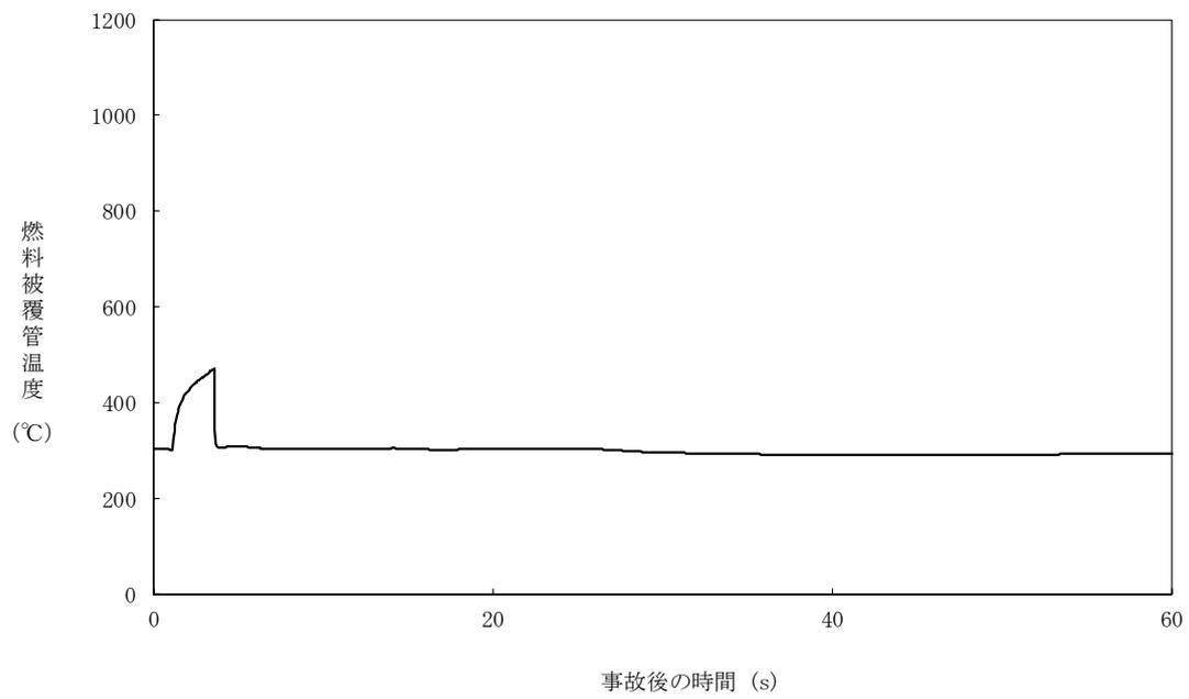
図 6.1.2-7 燃料被覆管温度の時間変化（原子炉冷却材流量の喪失+CCF）
