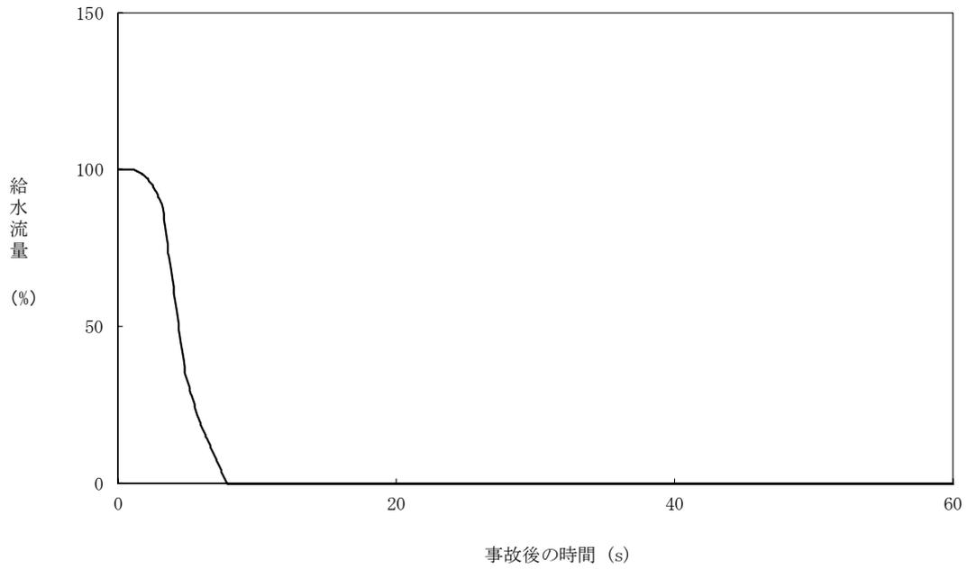
図 6. 1. 2-3 給水流量の時間変化 (原子炉冷却材流量の喪失+CCF)
