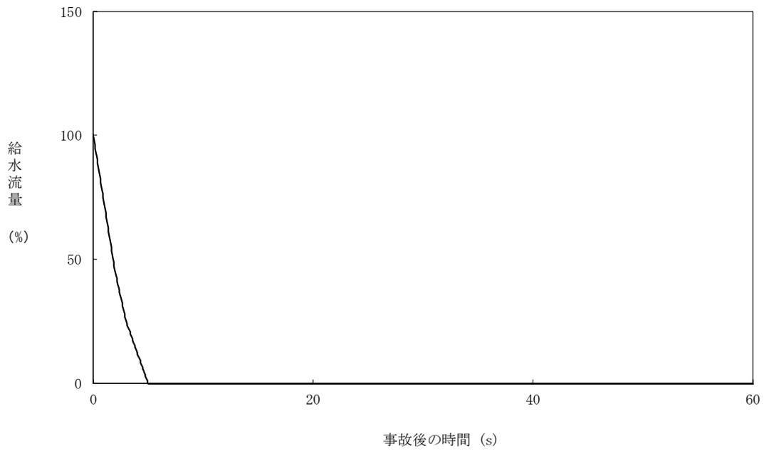
図 5.3.5-3 給水流量の時間変化（給水流量の全喪失+CCF）
