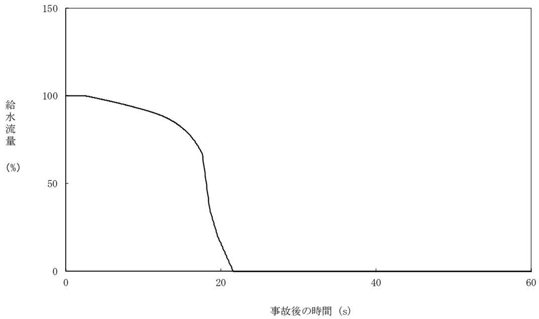
図 5.3.4-3 給水流量の時間変化（原子炉圧力制御系の故障+CCF）
