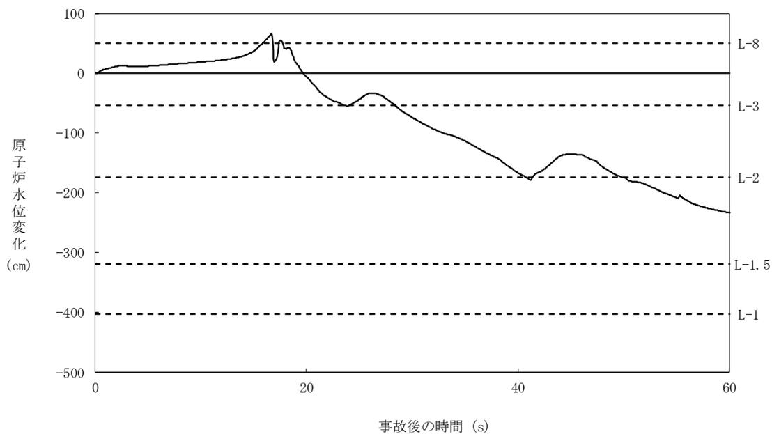
図 5.3.4-6 原子炉水位(シュラウド外水位)の時間変化 (原子炉圧力制御系の故障+CCF)
