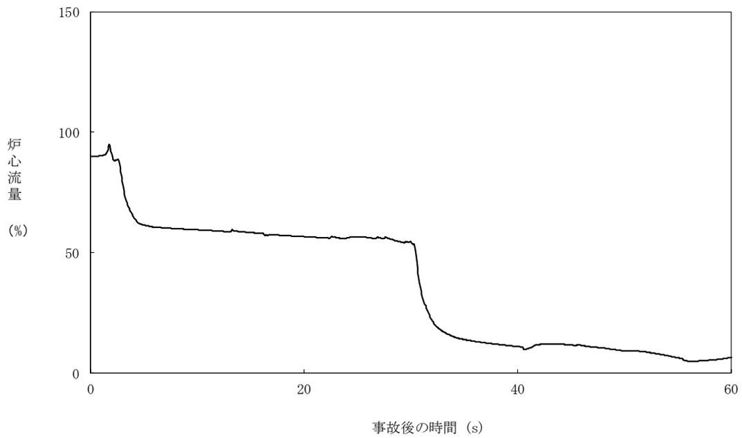
図 5.3.2-2 炉心流量の時間変化 (主蒸気隔離弁の誤閉止+CCF)
