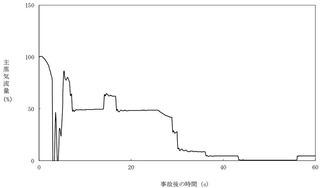
図 6. 1. 2-4 主蒸気流量の時間変化 (原子炉冷却材流量の喪失+CCF)
