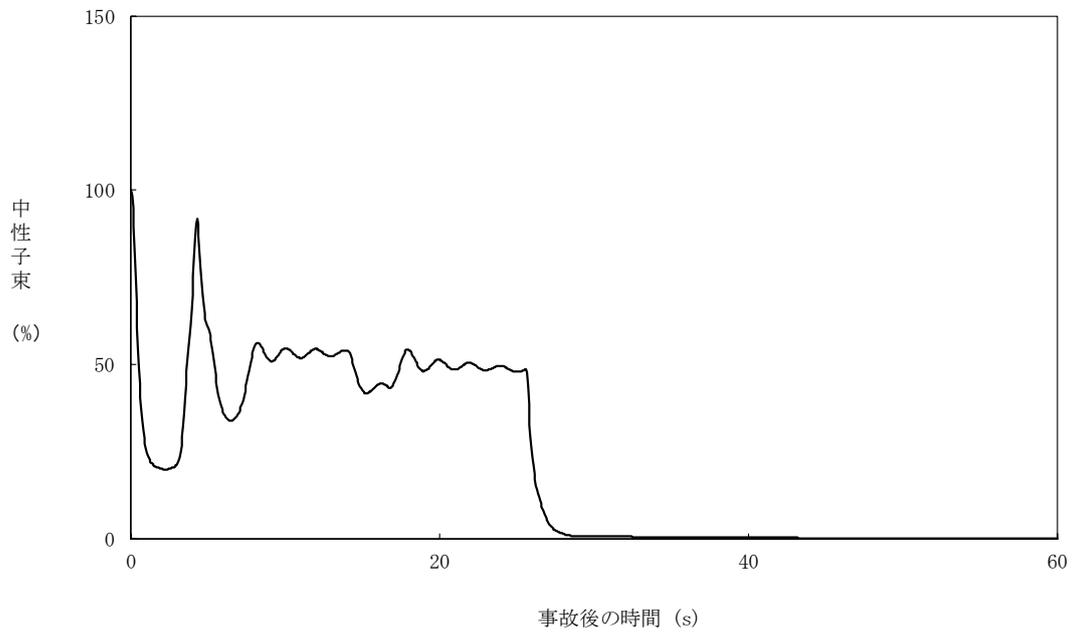
図 6. 1. 2-1 中性子束の時間変化 (原子炉冷却材流量の喪失+CCF)
