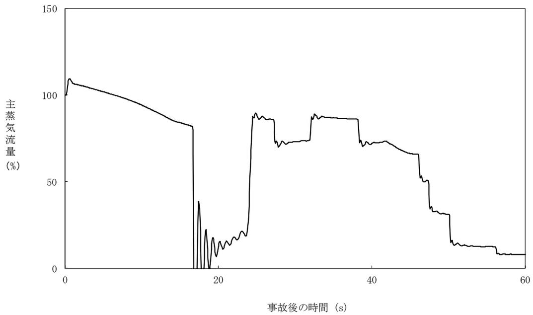
図 5.3.4-4 主蒸気流量の時間変化（原子炉圧力制御系の故障+CCF）
