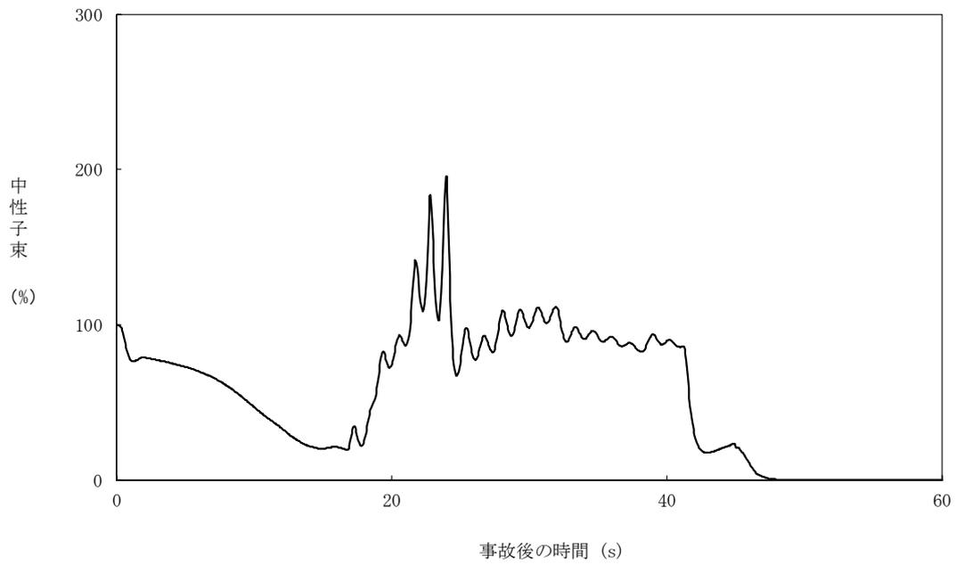
図 5.3.4-1 中性子束の時間変化（原子炉圧力制御系の故障+CCF）
