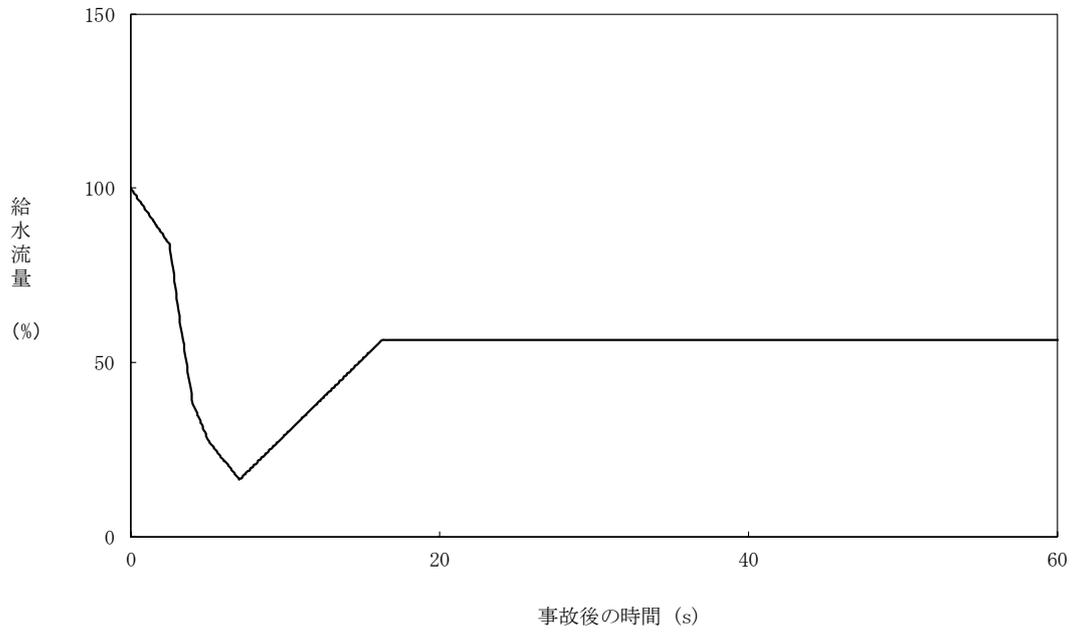
図 5.3.2-3 給水流量の時間変化（主蒸気隔離弁の誤閉止+CCF）
