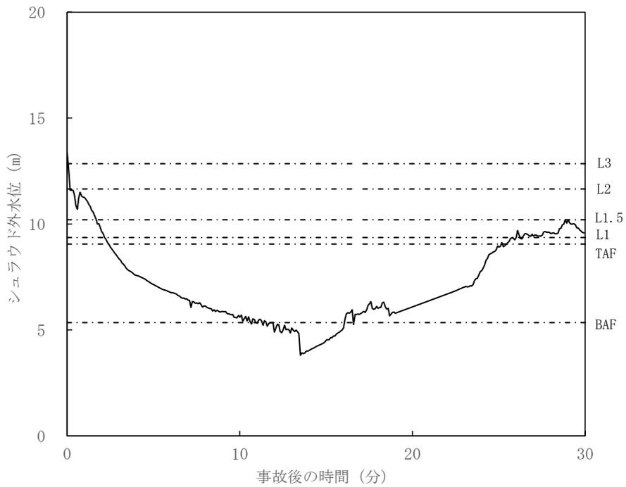
図 6.1.1-3 原子炉水位（シュラウド外水位）の時間変化
