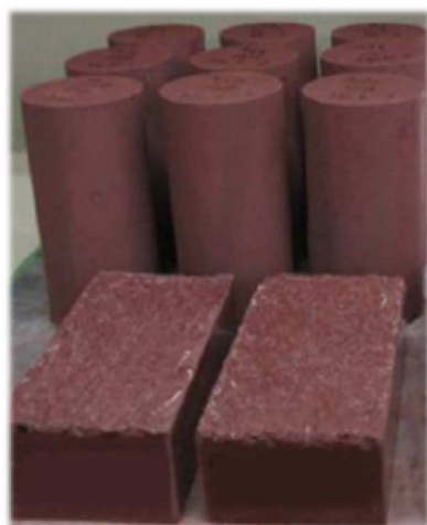
犠牲材コンクリート（硬化体）
