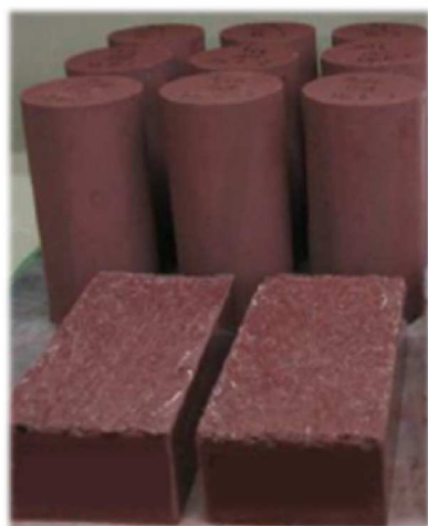
犠牲材コンクリート（硬化体）
