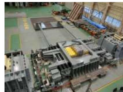
加振試験装置の例
