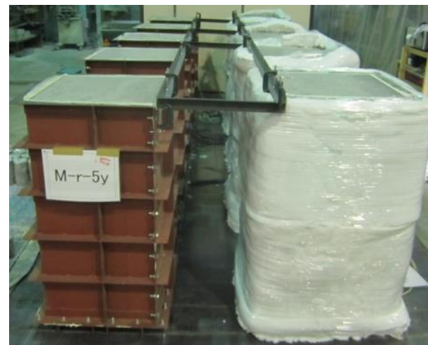
(左: 非加熱 / 右: 加熱) 写真－1 加熱試験状況
